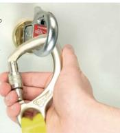
2 Oprimir el seguro y a continuación el gatillo. Seguidamente confrontar el perno de anilla con el centro del encastre. Empujar el perno de anilla con la palma de la mano hasta que se oiga bloquearse el mecanismo de enclavamiento.
